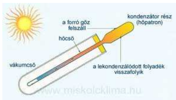
Vákuum csöves kollektor és a vákuumcső működése
