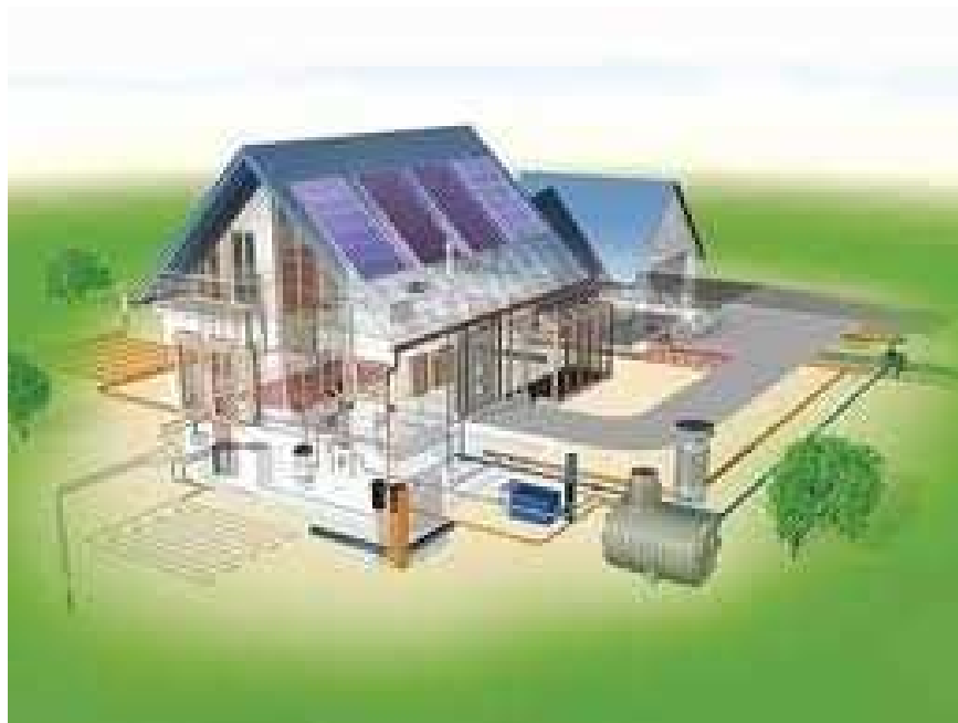
Horizontális talajszondás hőszivattyús fűtési rendszer
